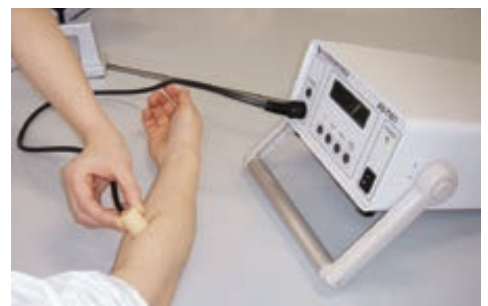
図5.10 経表皮水分喪失量（transepidermal water loss）を測定する電気湿度計
